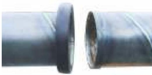
Fig. 11 – Detalhe de aplicação de lubrificante em tubulação
